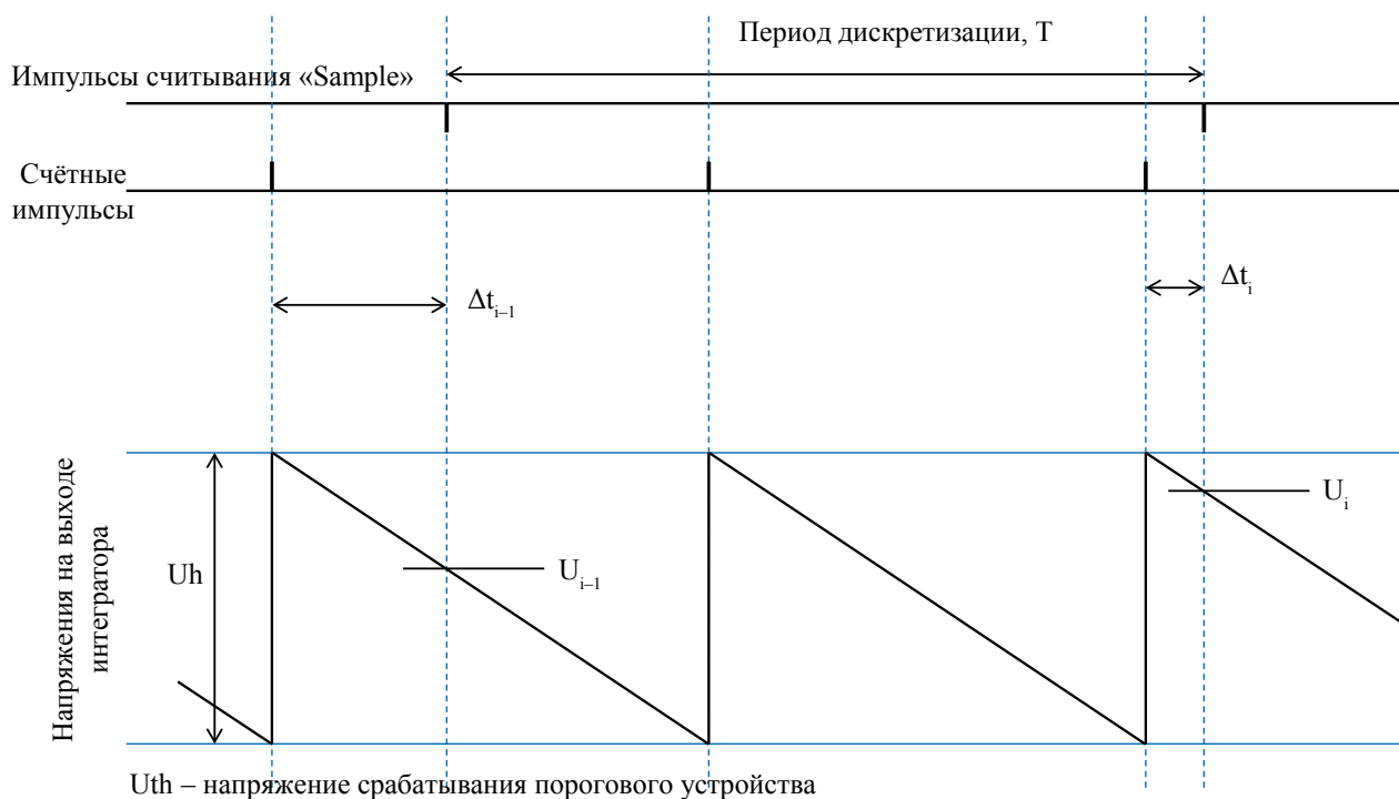
Рис. 2. Осциллограммы напряжения на выходе интегратора ПНЧ
