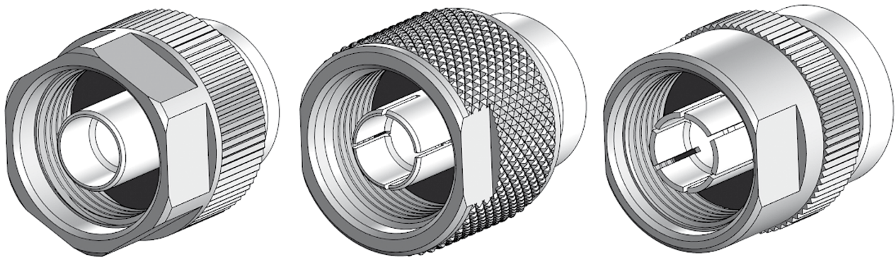
Рис. 5. Конфигурирование сборочной 3D-модели (подборки)
