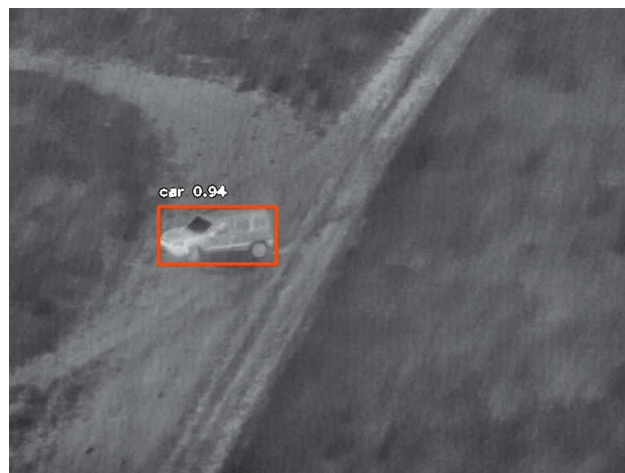
Рис. 6. Визуализация процесса распознавания для одного из кадров. Над рамкой, которой выделен обнаруженный объект, показан тип объекта, распознанного на кадре с максимальной вероятностью, и значение вероятности
