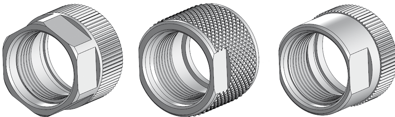
Рис. 3. Конфигурирование 3D-модели детали по значениям проектных параметров
