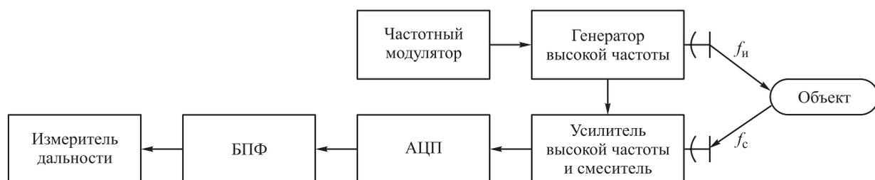
Рис. 1. Структурная схема дальномера:
