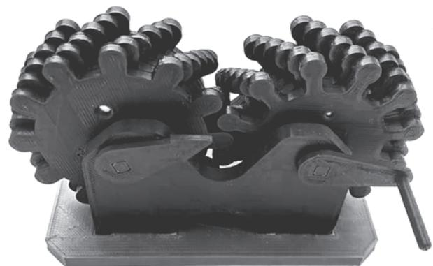
Рис. 9. Макет многорядного зацепления
